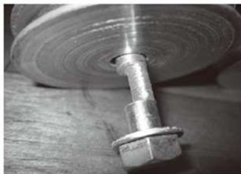
巻取器側滑車軸 ネット巻きでワイヤーを 巻く分摩耗が激しい
